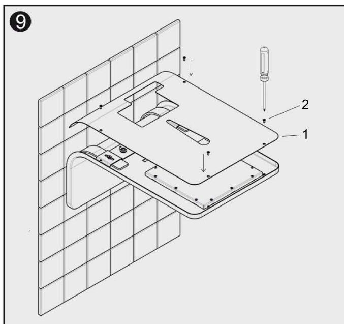
Ensamblar la tapa (1) utilizando las roscas (2) incluidas en el herraje.
