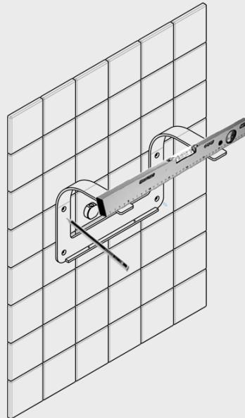
Apojar la trasera a la pared y señalar la posición de los tacos para la siguiente fijación de la trasera.
