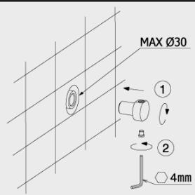
Atornillar el racor (1) al tubo de 1/2" predisposto en el muro y atornillar el tapón (2).
