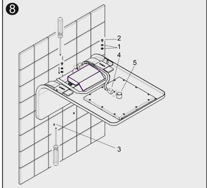
Bloquear a través de las arandelas (1), las roscas (2) las roscas (3). Atornillar por lo tanto el flexible (4) al racor (5).
