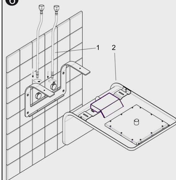
Atornillar el flexible (1) e insertar el cuerpo externo (2) sobre la trasera.
