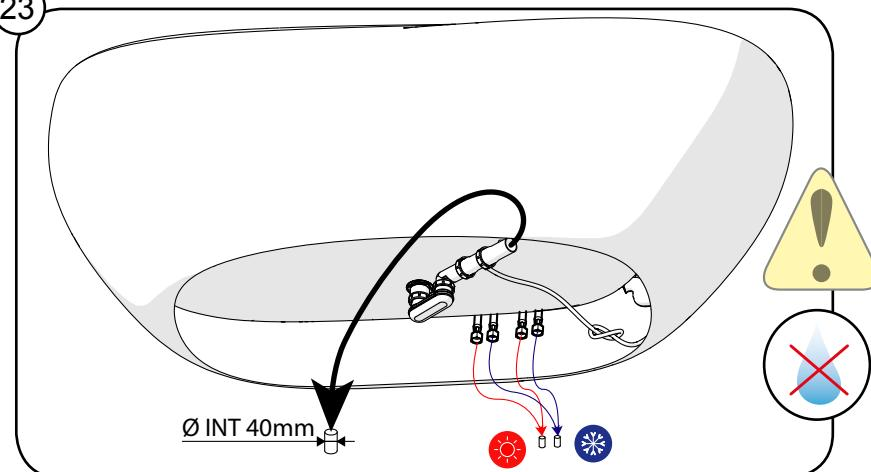
Asegúrese de que la bañera no está completamente sellada al suelo para permitir la entrada de aire a través de la válvula.
